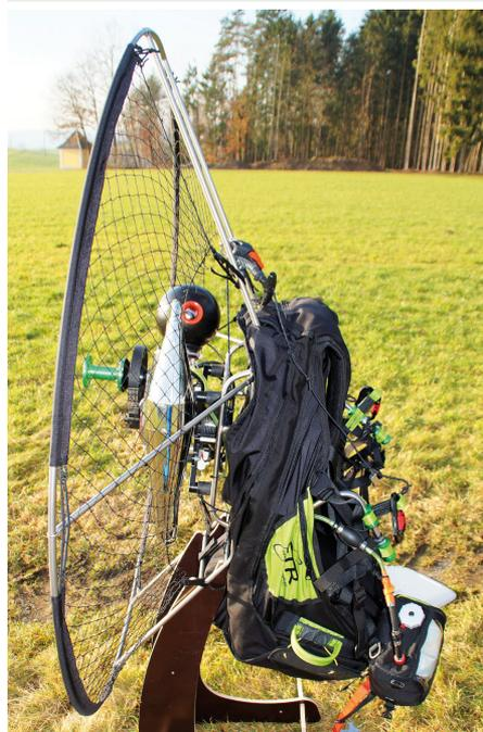
Flügel. Last but not least zeichnet auch das geringe Gesamtgewicht von ca. 15 kg inkl. Gurtzeug (16,8 kg mit einer 125-kg-Rettung) sowie die gesamte Rahmenkonstruktion, die spezielle Geometrie, verantwortlich für den hohen, freiflugähnlichen Sitzkomfort in allen Fluglagen.
